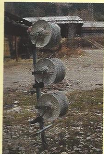
L'enrouleur à fils facilite le travail de pose et de dépose de la clôture
